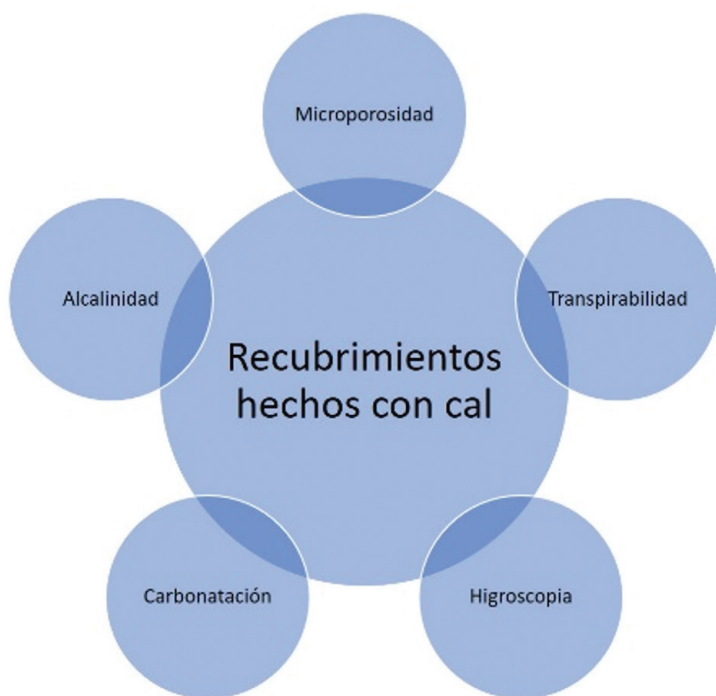
Imagen 2. Características de los recubrimientos hechos con cal. Creación propia.
