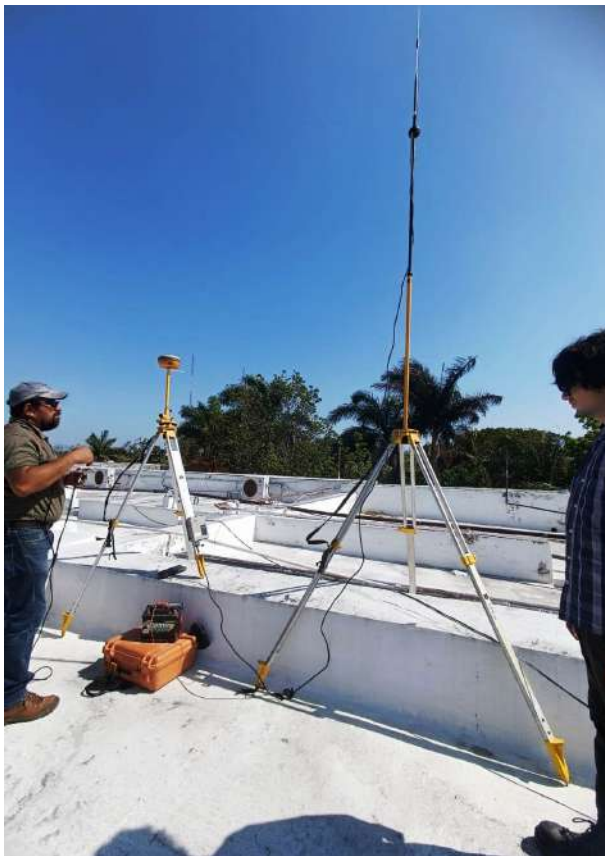
Figura 1. Colocación de puntos de control en la azotea del ex convento de la Mejorada. Foto: Melissa Pérez Pérez, 2023.
