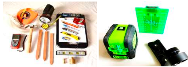
Figura 10. Instrumentos de utilidad para los registros y levantamientos. A la derecha: nivel láser autonivelante línea verde cruzada con ajuste de brillo.
