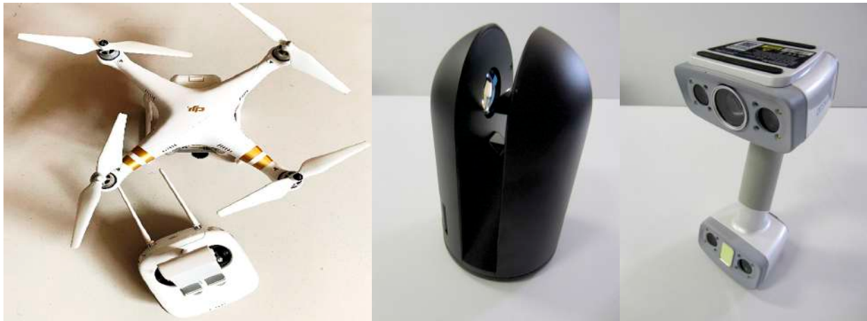
Figura 15. Dron para el registro fotográfico; escáner 360 para levantamientos de espacios internos y externo y escaner manual de alta resolución. Fotos: Archivo Torres Salomao, 2017 y Archivo Laboratorio Diseño del Hábitat Humano Analógico Digital, UASLP, 2024.
