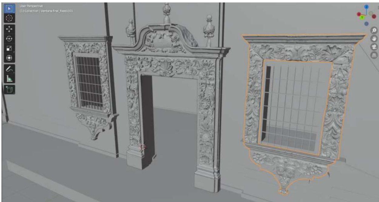
Figura 3. Modelo detallado en Blender del enmarcamiento y las guardamalletas de la capilla de la Caja Real. Fuente: Laboratorio del Diseño del Hábitat Humano Analógico-Digital (DHHAD), Facultad del Hábitat, 2023.
