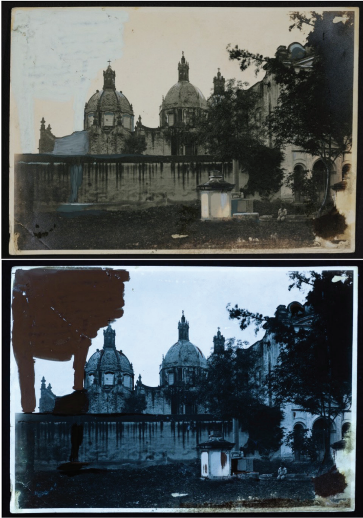
Figura 5. Documentación técnica de un positivo fotográfico con retoques. Arriba, muestra registrada bajo luz visible y abajo, mediante fluorescencia inducida por luz ultravioleta.
